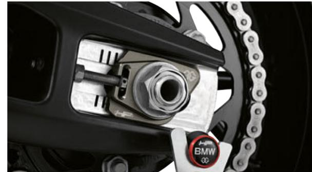
Der HP Kettenspianner ermöglicht die hochpräzise Einstellung von Kettenspannung und der Hinterradausrichtung. Gleichzeitig erleichtert er den Einbau des Hinterrads, da er fest mit der Schwinge verbunden bleibt.
