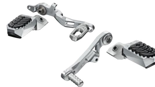
Die Aluminium-Fahrerfußrasten Classic mit Trittplatten aus Kunststoff sind in drei Positionen einstellbar und bieten on- wie offroad ein Höchstmaß an Komfort und Trittsicherheit. Die hochwertigen Frästeile der exklusiven Option 719 bieten besonders im Gelände zusätzlichen Halt und eine noch bessere Kontrolle der Maschine beim Fahren im Stehen.
