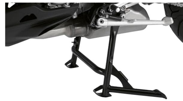
Der stabile Hauptständer sorgt für einen sicheren Stand der Maschine auch in Hanglagen und bietet Vorteile etwa beim Tanken, bei der Montage von Koffern und Topcase oder bei der Reifendruckkontrolle. Außerdem benötigt die aufrecht geparkte Maschine weniger Raum.
