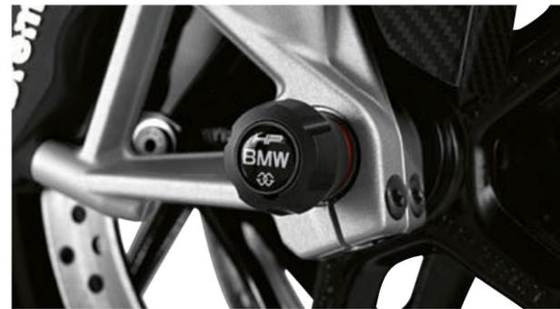
Die HP Achsprötektoren für die Vorderachse bestehen aus hochabriebfestem Kunststoff. Sie sind mit einem BMW und HP Schriftzug versehen und schützen die Vorderradgabel bei Stürzen und Umfallen vor Kratzern.
