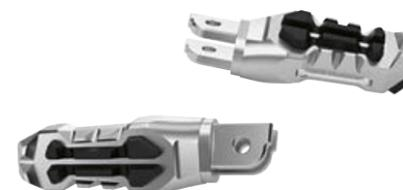
Die M Fahrerfußraste aus eloxiertem Aluminium betont mit ihrer Oberfläche in Schwarz/Silber und BMW Branding die dynamische Optik der Maschine. Die geriffelte Trittläche gibt zusätzlichen Halt, vibrationshemmende Gummieinleger sorgen für mehr Fahrzeugkontrolle. Ein austauschbares Schleifpad ermöglicht mehr Schräglagenfreiheit.
